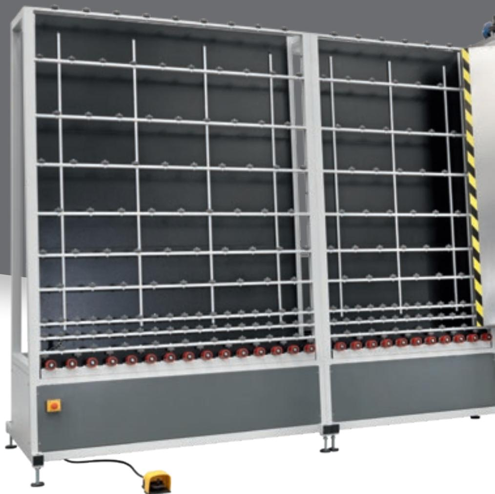
La **série Aqua** est la gamme de laveuses InterMac, pouvant être complètement intégrées avec les centres d'usinage verticaux, qui permettent le lavage et le séchage des vitres façonnées selon les standards les plus élevés. Aqua garantit une propreté extrême de toutes les impuretés accumulées pendant le façonnage sur les volumes et une préparation parfaite des volumes pour l'usinage suivant ou pour la sortie de cycle de façonnage.
