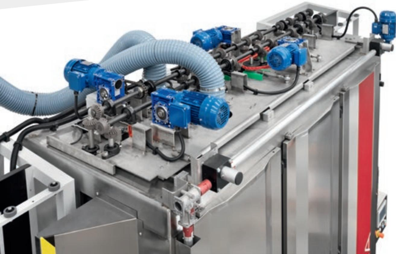
**Système de transmission des rouleaux et brosses** positionné dans la partie supérieure de la machine pour une meilleure protection contre l'eau et pour faciliter l'inspection et l'entretien.
